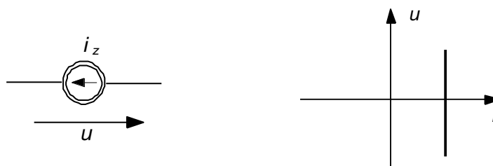
Rys.6. Symbol i charakterystyka idealnego źródła prądu
