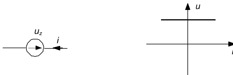
Rys.5. Symbol i charakterystyka idealnego źródła napięcia
