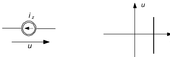
Rys.6. Symbol i charakterystyka idealnego źródła prądu
