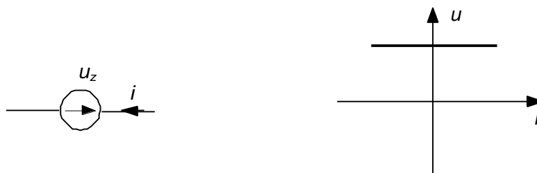
Rys.5. Symbol i charakterystyka idealnego źródła napięcia
