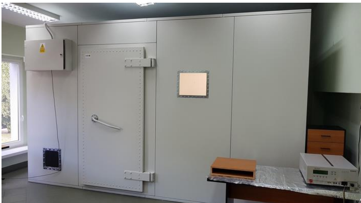
Komora ekranowana z urządzeniem badanym wewnątrz.
