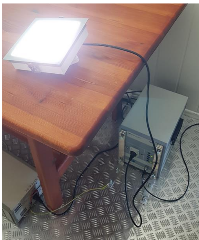
EUT na stanowisku do badań emisji przewodzonych.
