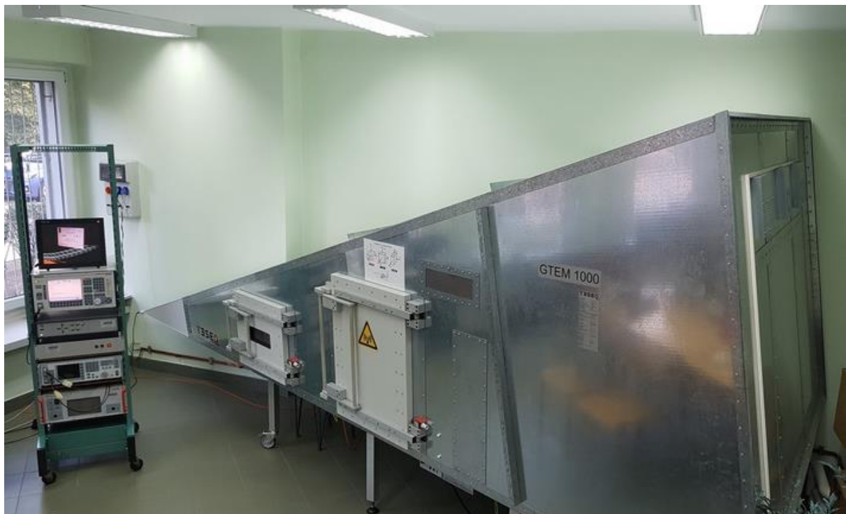
Odbiornik pomiarowy na stanowisku sterowania pomiarem zaburzeń radioelektrycznych obok komory GTEM-1000.
